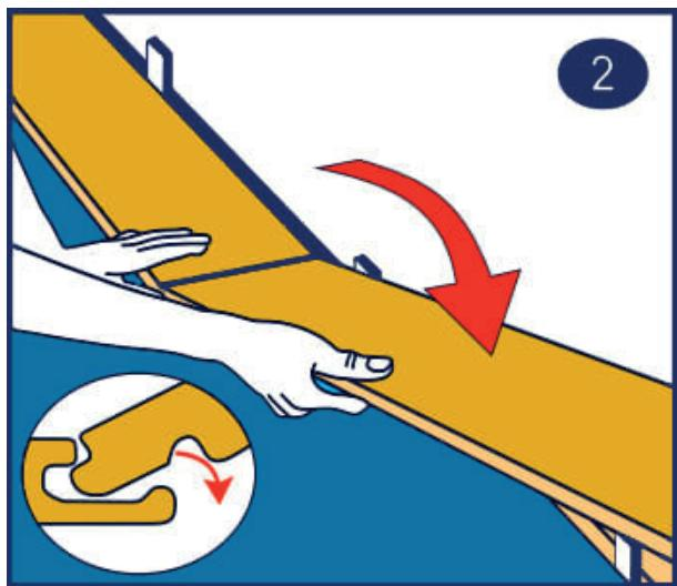
**Если вы заметили, что ламели плохо стыкуются и не находятся на одной высоте, разберите полы. Еще раз проверьте чистоту основания на предмет мусора, и выровненности. Плохо подготовленное и не очищенное основание чернового пола может привести к деформации и порче замкового соединения.**
