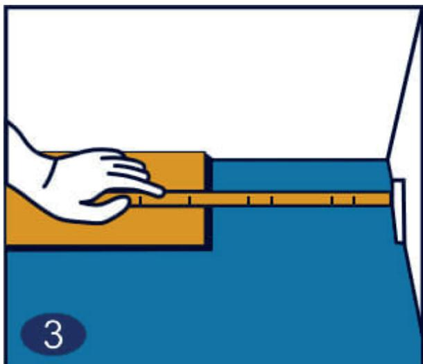
Для того, чтобы подпилить доску вам потребуется канцелярский нож и линейка. Сделайте линию на задней стороне планки. Затем, используя нож, разрежте планку по линии (рис. 4).
