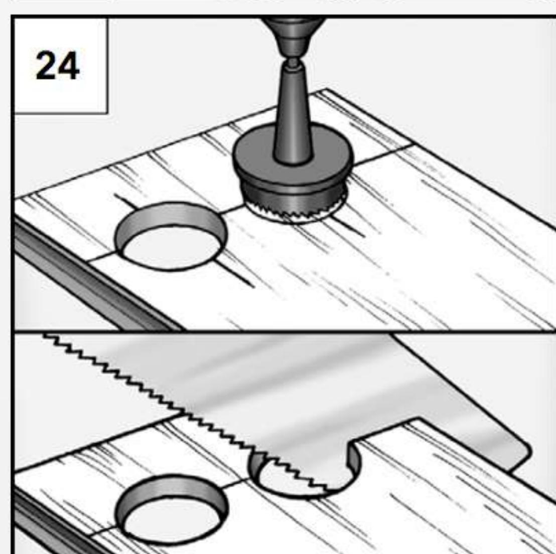
24. Используя дрель и нужные насадки, просверливаются круглые отверстия под трубы на досках.
