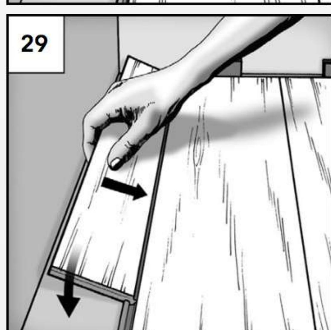
29. Дальше происходит укладка пола по тому же принципу, что и предыдущие ряды. Бывает, что по каким-то причинам невозможно установить панель (например мешают радиаторы). В этом случае придется спилить часть замка и уже крепить доску с помощью жидких гвоздей.
