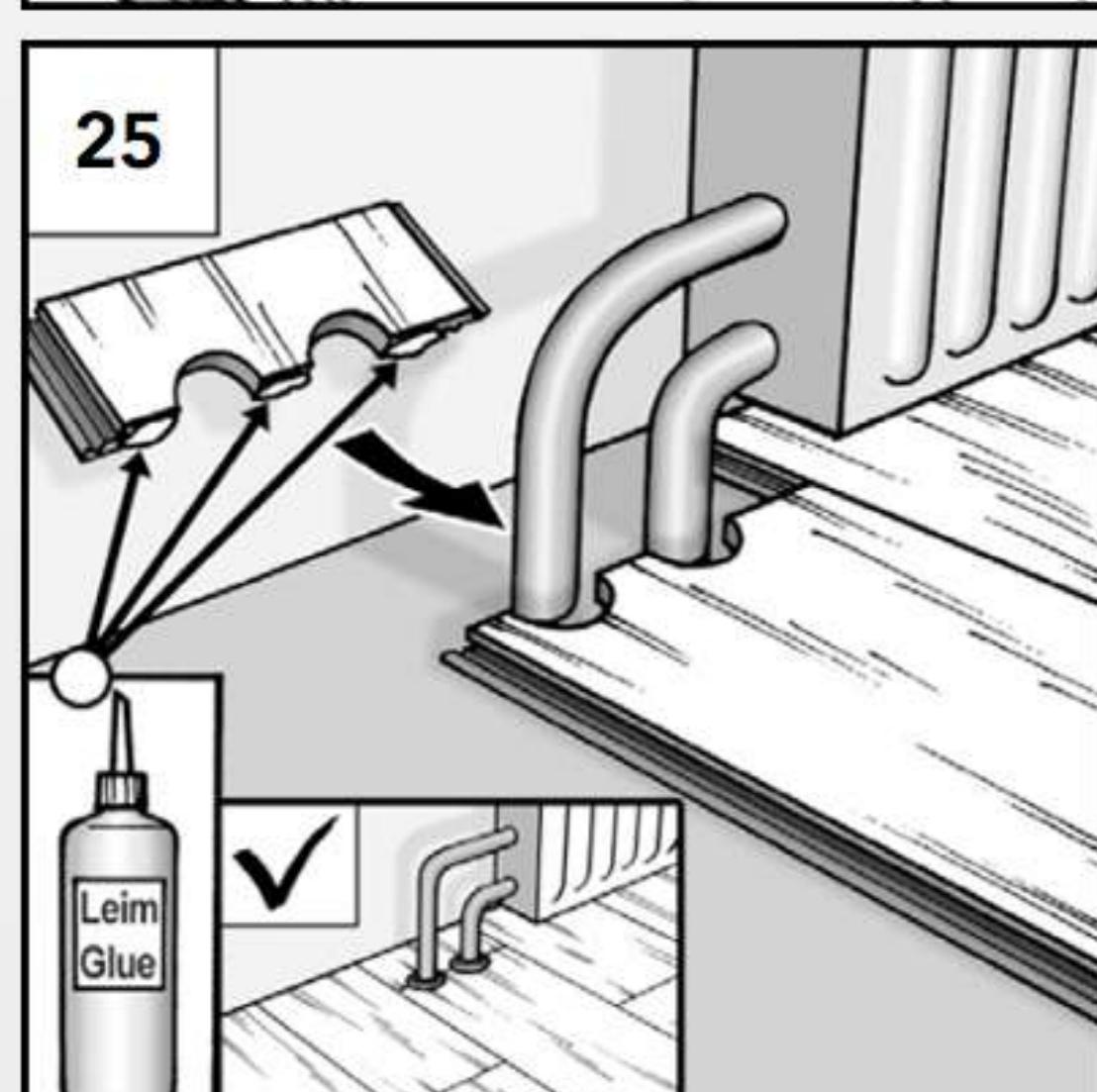
25. С помощью жидких гвоздей соединяем доски с отверстиями между собой торцами, установив их вокруг труб отопления. Вот по такой схеме можно обойти любые трубы и смонтировать пол вокруг них без проблем.
