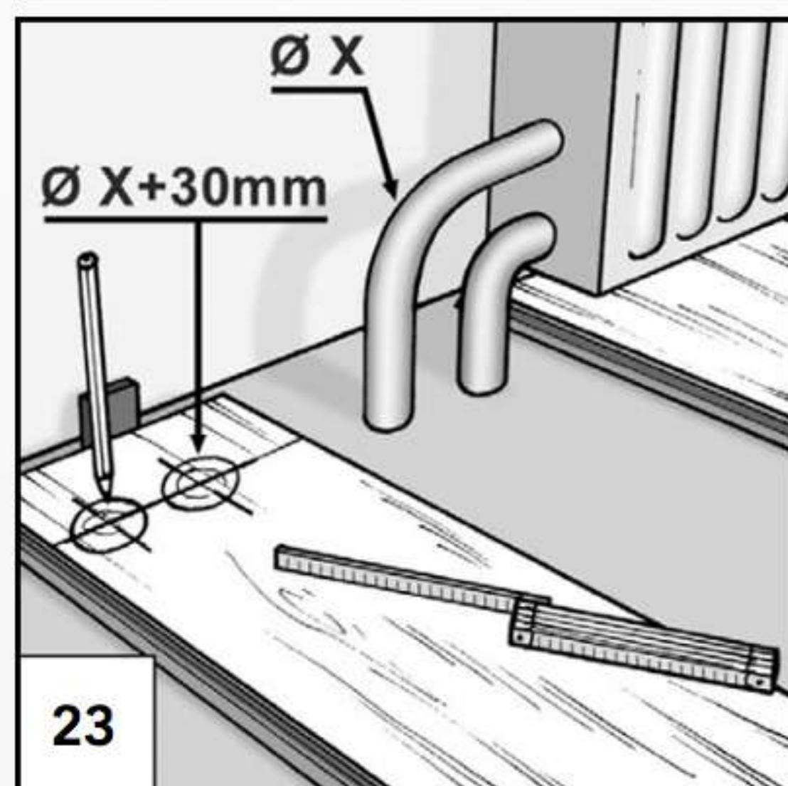
23. Часто приходится монтировать пол вокруг труб отопления. Это самый сложный и неприятный момент. Для этого сначала делается разметка под эти трубы. Измеряется расстояние их от стены, между ними и их диаметр.
