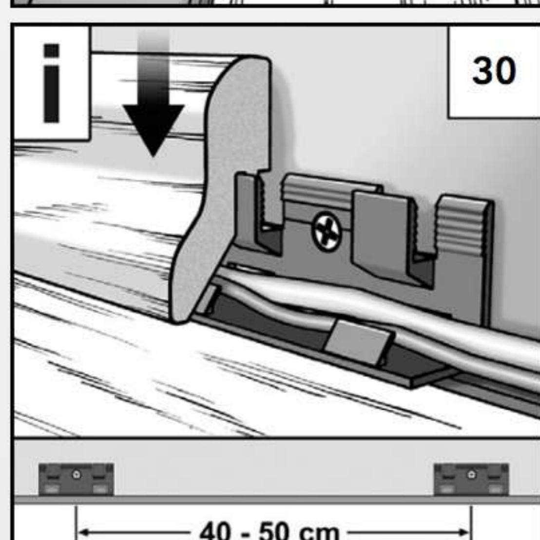
30. После укладки пола наступает следующий этап – установка плинтусов. Далее приведена схема, по которой происходит крепление плинтуса с помощью клипс. Последние монтируются к стене посредством дюbelь-гвоздей на расстоянии 40-50 см друг от друга. В нижнюю часть клипсы также можно разместить кабель.
