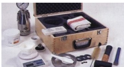
Прибор для измерения остаточной влажности стяжек по карбидному методу (СМ)
