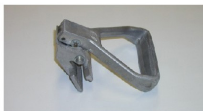
приспособление для зачистки (обдирки) напольных покрытий
