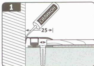
Все места по краям/на стыках со стенами, где нельзя устанавливать плинтусы или напольные профили, необходимо защитить от проникновения влаги нетвердеющим герметиком (силиконом).
