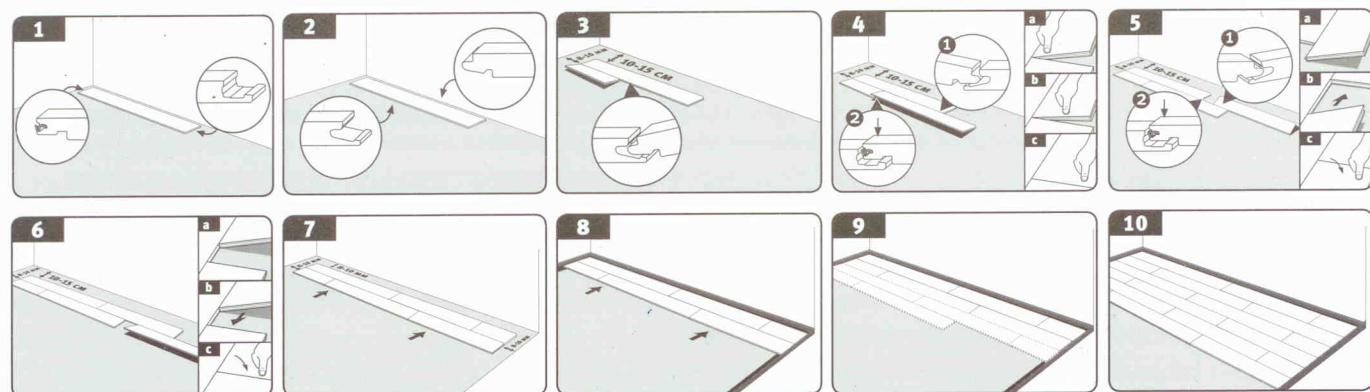
**ВНИМАНИЕ!** При укладке торцевые стыки панелей каждого последующего ряда должны быть смещены минимум на 200 мм относительно стыков панелей предыдущего ряда. Укладывая покрытия с фаской и/или особым декором (например, имитирующим плитку), необходимо следить, чтобы смещение было равномерным и соответствовало фаске и/или рисунку.
